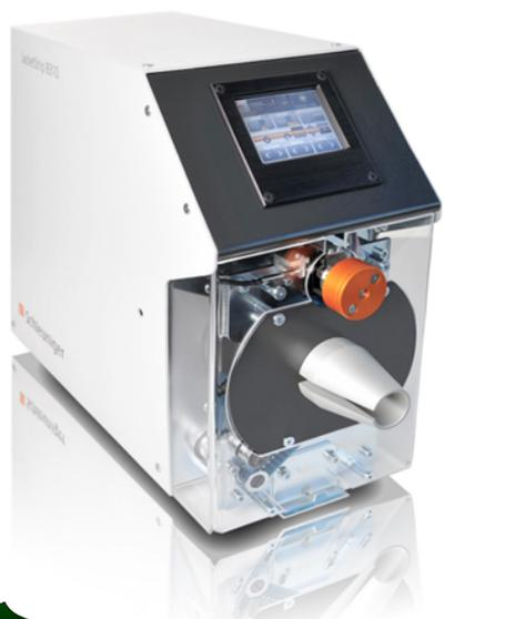
La JacketStrip 8310 permet d'effectuer des incisions axiales et radiales sur la gaine isolante de câbles simples ou multiconducteurs de diamètre 2.5 mm à 25 mm et jusqu'à 500 mm en longueur de dégainage. Avec son système de lame mobile unique, la JS8310 permet le dégainage de câbles torsadés, sans endommager les conducteurs intérieurs ou le blindage.
