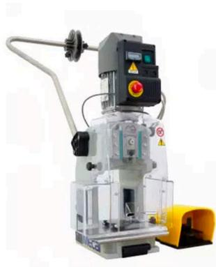
La nouvelle presse de sertissage MECAL TT est conçue pour le sertissage de fils jusqu'à 6 mm<sup>2</sup>.
